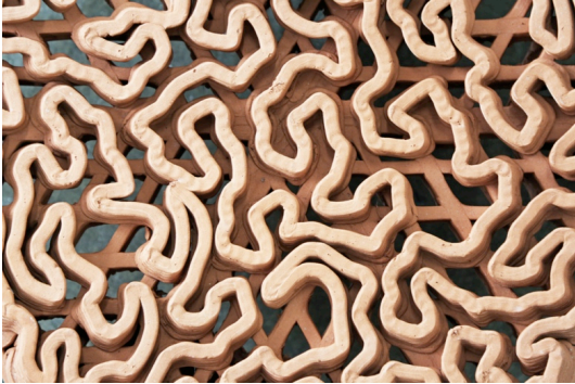
圖四：團隊運用 3D 粘土打印技術，將一般赤陶土打印出 128 塊直徑為 600mm 的礁石。（圖片鳴謝: Christian J. Lange）
